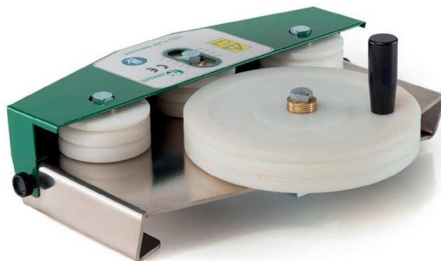
PROFLEX MACHINE - macchina manuale per curvare i profili proflex line
